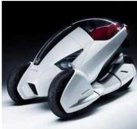
Трехколесная Honda 3R-C расстояния. Энергоблок установлен непосредственно на трехколесном шасси, в результате этого понижен центр тяжести, что улучшает устойчивость всей конструкции.
