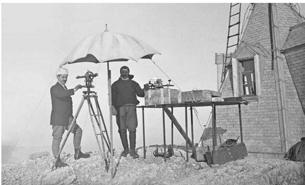
Топографы на вершине горы Сантис измеряют скорость ветра при помощи анемометра, 1915 (swisstopo.admin.ch)
