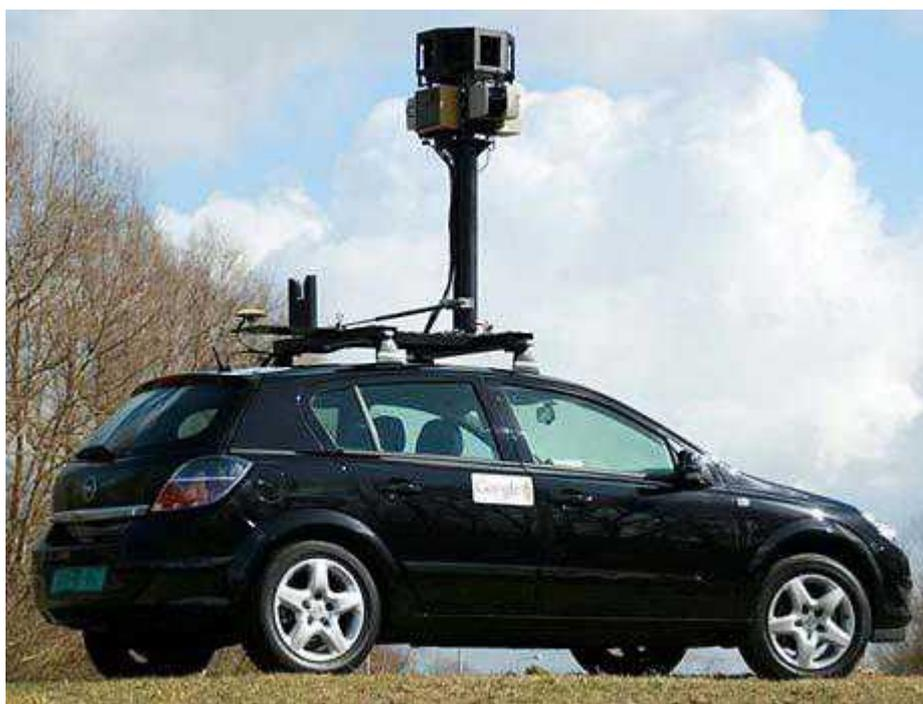
Камеры, при помощи которых ведется запись, крепятся на машинах со специальной платформой высотой в 2.75 метра. Этого достаточно для того, чтобы заглянуть через средний забор.
