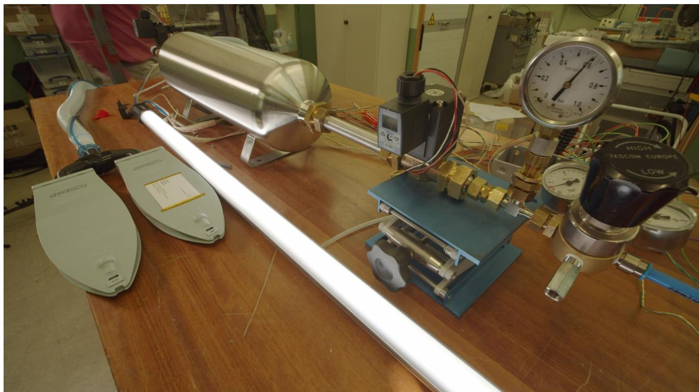
Прототип нового аппарата ИВЛ (© 2020 CERN)
