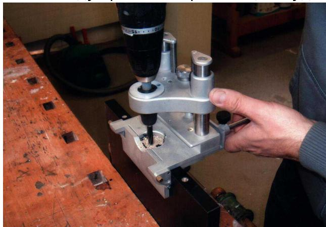
– ручной дрелью (Швейцария) с набором инструментов, которая позволяет просверлить серию отверстий, лежащих на одной прямой и на одинаковом расстоянии друг от друга;
