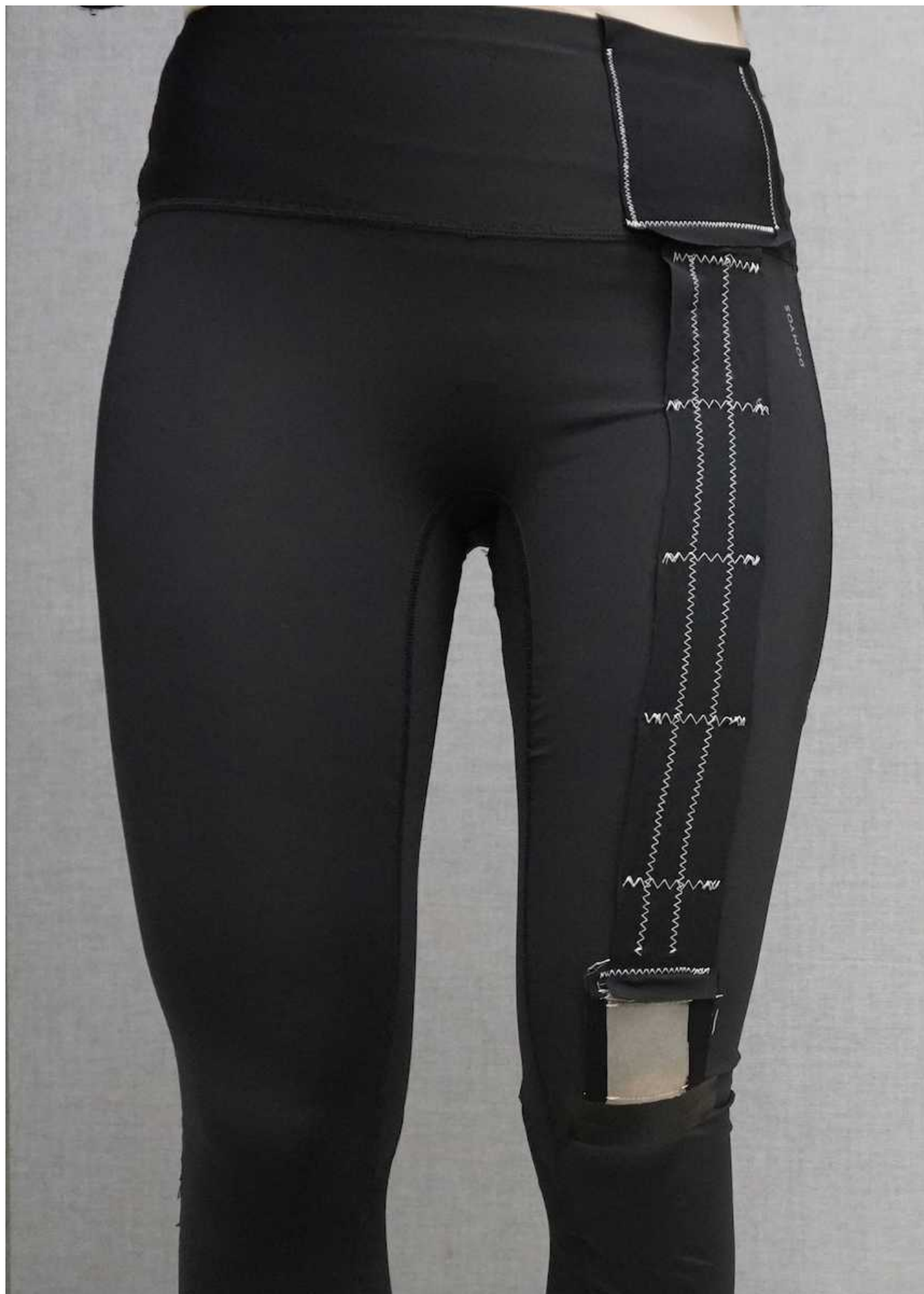
Текстильный датчик над коленом соединен с антенной, встроенной в пояс брюк. Фото: Valeria Galli / ETH Zürich
