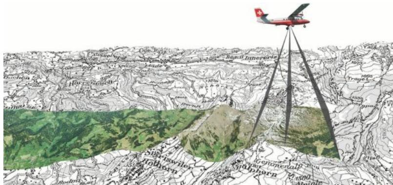
Процесс аэрофотосъемки ([swisstopo.admin.ch](http://swisstopo.admin.ch))
