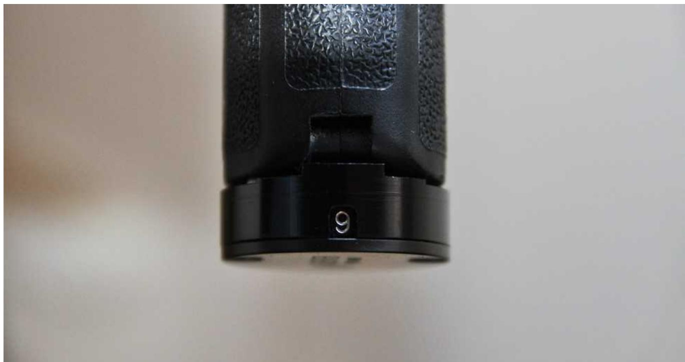
Механический счетчик патронов внизу рукоятки едва заметен (swiss-observer.ch)
