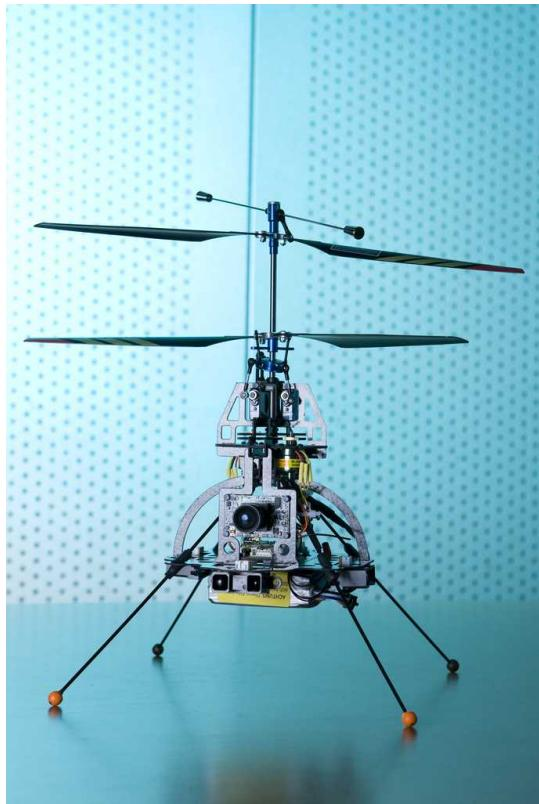
Основа беспилотного вертолета компании Skybotix ([skybotix.com](http://skybotix.com)) – вертолеты, способные оставаться в воздухе несколько часов. Цель их – в первую очередь наблюдение, но и они не применяются в военных целях. Недавно три таких аппарата прошли испытания в Черном и Балтийском морях, где они вели наблюдения за ветроустановками и за тайным выбросом газов.
