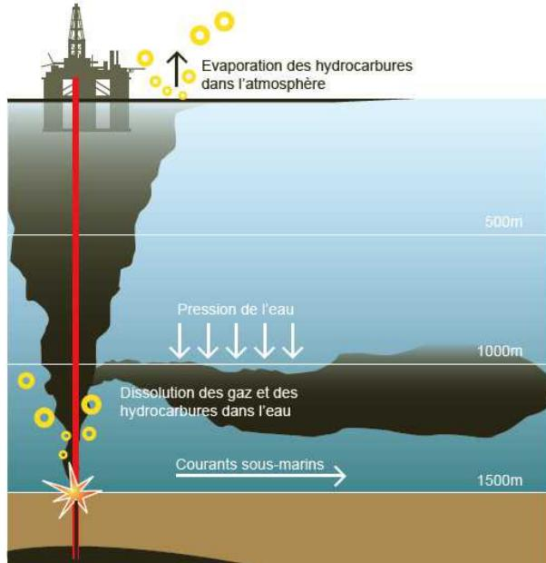
Сравнив состав нефти на выходе из буровой скважины и на поверхности, сотрудники Лаборатории моделирования химии окружающей среды и Океанографического Института Woods Hole смогли объяснить формирование и состав горизонтального потока загрязнения. Его образование связано с растворением на глубине 1000 метров некоторых газов в результате давления воды. Часть нефти уходит из вертикального «столпа» именно таким путем и продолжает движение в океане.
