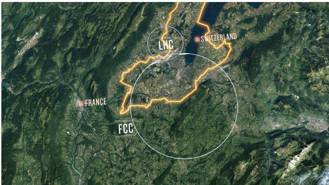
Сравнение размеров Большого адронного коллайдера и будущего ускорителя (cern.ch)
