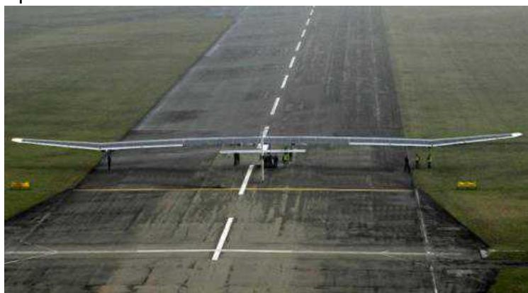
Размах крыльев самолета 63,4 метра [© Solar Impulse]
